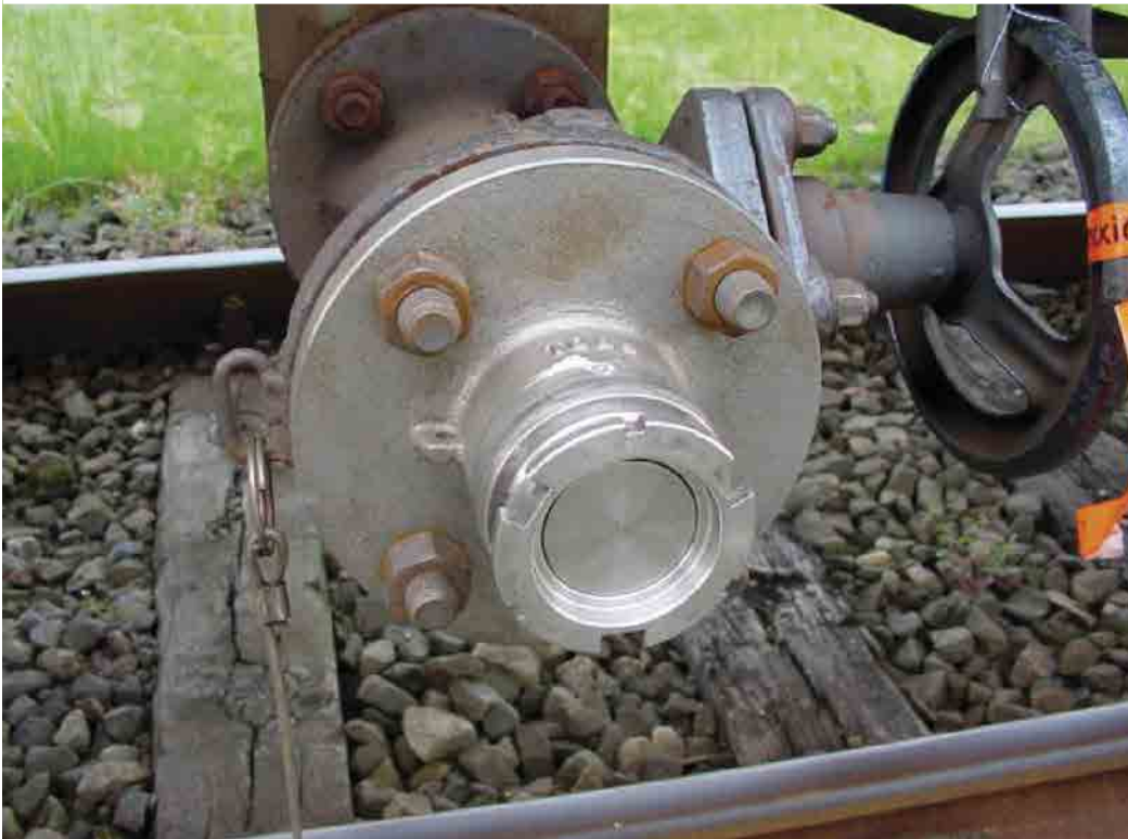
Fig. 2 Verbindung zur Trockenkupplung
