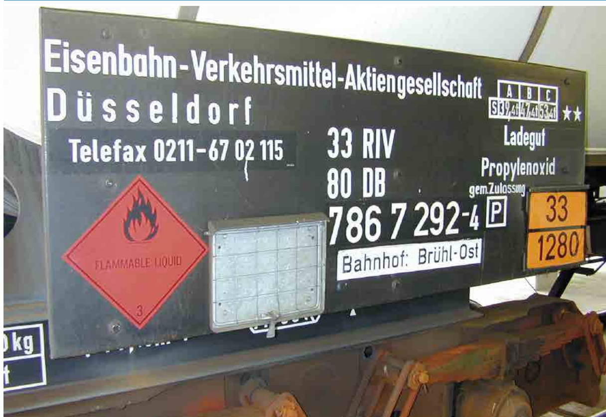
Fig. 1 Wagentafel eines Propylenoxid Kesselwagens
